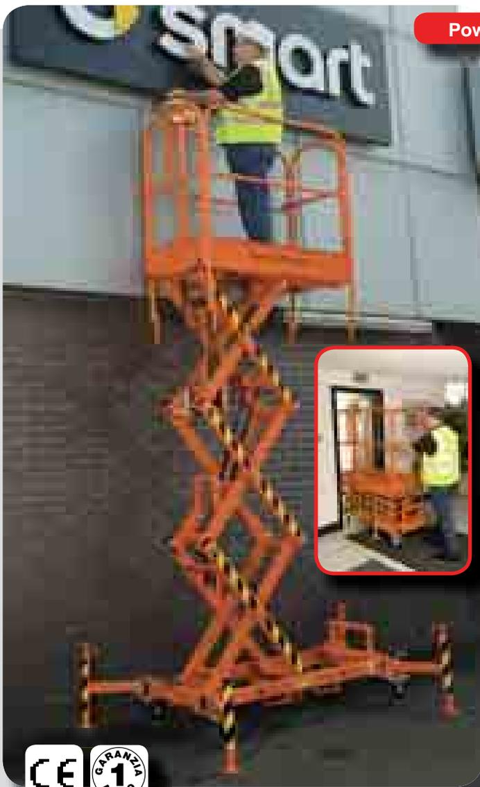
Piattaforme aeree a pantografo a spinta. Con alimentazione per la salita e la discesa a mezzo trapano elettrico dal cestello.
