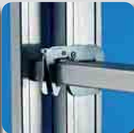
I pioli con superficie d'appoggio di mm 30 vengono fissati ai montanti tramite ribordatura. Sono zigrinati e antisdrucchiolo per una solida presa di mani e piedi. Un gancio di sicurezza impedisce lo sfilo accidentale dell'ultimo tronco.
